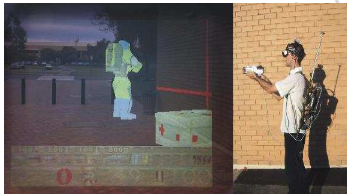
Obr.3 Komponenty systému ARQuake a pohľad používateľa
